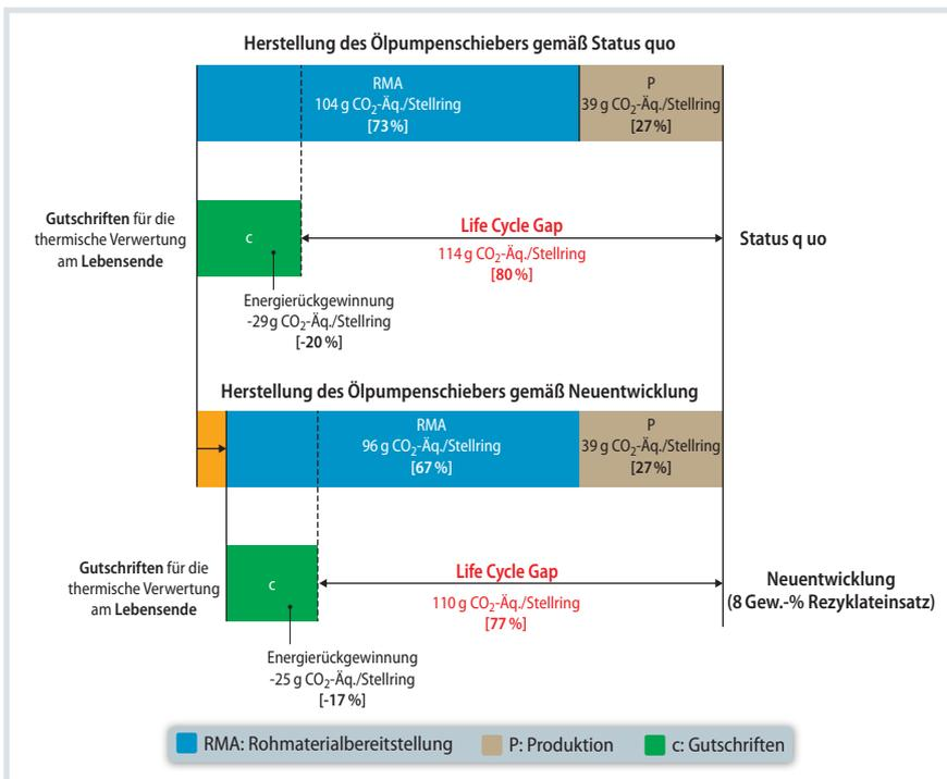
**Bild 6.** Ergebnis der „Life Cycle Gap“-Analyse. Durch den Einsatz von 8 Gew.-% Rezyklatmaterial wird die Lücke zur idealen Kreislaufführung um 3 %-Punkte reduziert. Quelle: Fraunhofer ICT; Grafik: © Hanser
